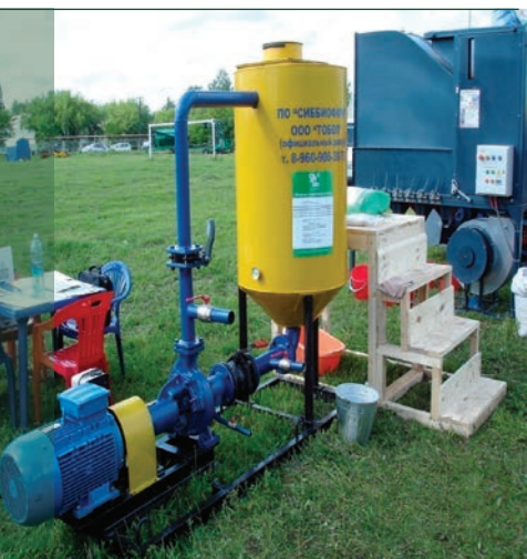
Известная практикам установка УЖК-500 для приготовления жидкой кормовой патоки
